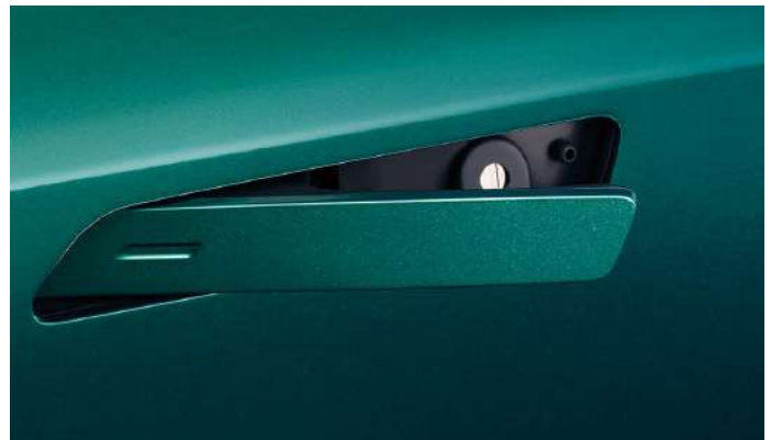
Təkmilləşdirilmiş aerodinamika üçün gizli çəkiliş bilən tutacaqlar
