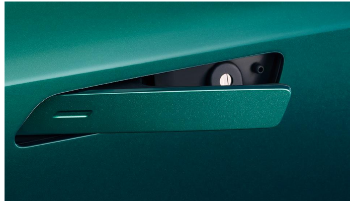
Təkmilləşdirilmiş aerodinamika üçün gizli çəkilə bilən tutacaqlar
