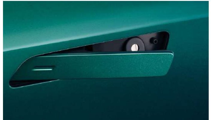
Təkmilləşdirilmiş aerodinamika üçün gizli çəkilə bilən tutacaqlar
